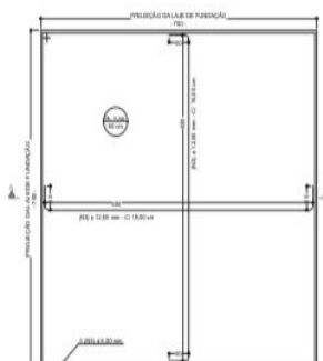
ARMADURA INFERIOR DA LAJE DE FUNDAÇÃO FIGURA 108
